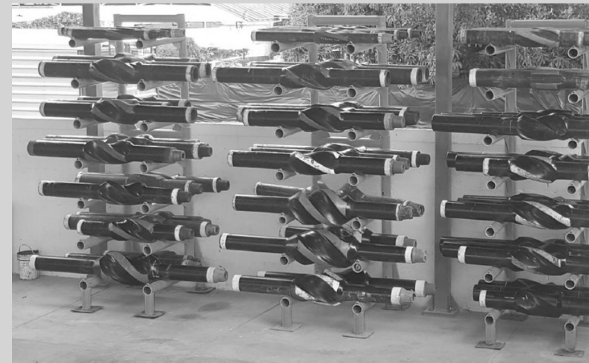
Rack Principal de Estabilizadores
